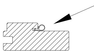
4. Sluttstykket justeres for korrekt lukking.
