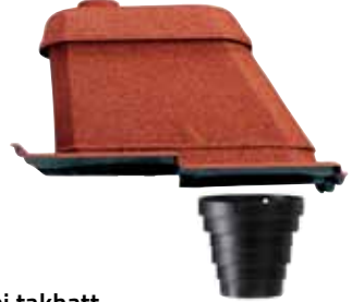
Kombi takhatt Benyttes til mekanisk eller naturlig ventilasjon og soilutlufting. Tilkobling til rørdiam. 160,150,130,125,110 og 100 mm.
