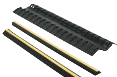
Møneventilasjonsbånd/mønelist Benyttes over mønekam. Tetter mot inndrev, men slipper ut luft. Dekkes av mønekappe. Lengde 1000 mm.
