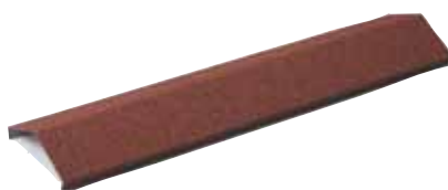
Møne rett Dekkende lengde 1150 mm. Møne-valminndekning for fall fra 10° til 18-20°.
