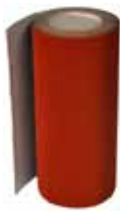
Icoflex Alu Butylbånd Bredde: 300 mm. Lengde: 5 m. Selvklebende butylbånd med kreppt alu.folie. Tetting rundt gjennomføringer og ved overganger. Farge: sort, rød.
