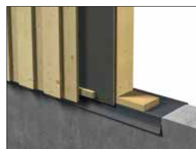
D7. Overgang mur og vegg
