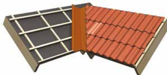
Bild 15. Utförande av rännedal Rännedalar är känsliga delar av takkonstruktionen och skall utföras omsorgsfullt. Pannorna skall kapas i raka linjer och spolats rena från damm omgående.
