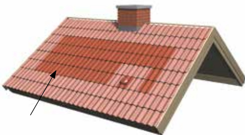
Bild 11. De ljusst markerade pannorna fästes alltid.
