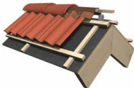
Bild 13. Benders nock och valmtätningrulle är lätt att montera. Rulla ut en längd på nockplankan, spika eller häfta fast den. Ta sedan bort skyddstejpen på undersidan av rullen och tryck fast och forma mot takpannorna. Underlaget skall vara torrt och dammfritt och temperaturen bör vara minst +8°. Nock- och valmtätningrullen finns i 300 mm bredd.
