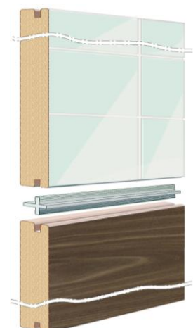
Fig. 15 Forlengelse i høyden med skjøteprofil med synlig fuge
