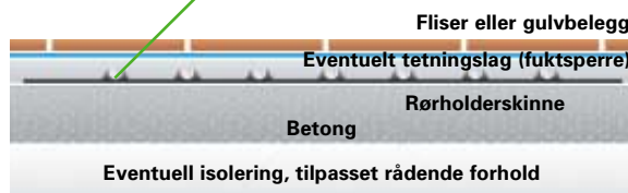
Gulvvarmerør Wirsbo-evalPEX 12x2 mm Utjevningssmasse -Overdekning over rør min. 15 mm inkl. eventuelle fliser
