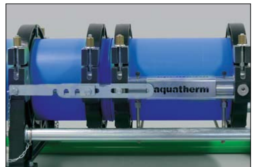
Trekk sammen rørene. La kjøle under trykk.
