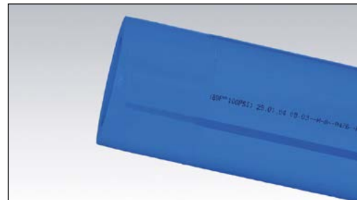
Kuttet, skrapet og rengjort - klart for sveising
